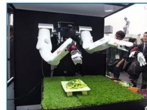
多指ハンドを装着した双腕型ロボットアームを持つ「マルチモーダルAIロボット」(クリックで拡大)
