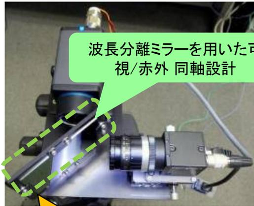
可視カメラ/赤外カメラの2台を搭載したカメラ
