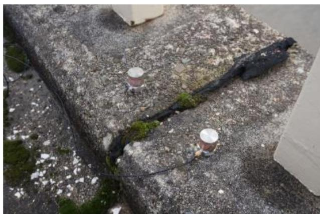
写真3-④-(1)-3.7 加速度センサの設置状況
